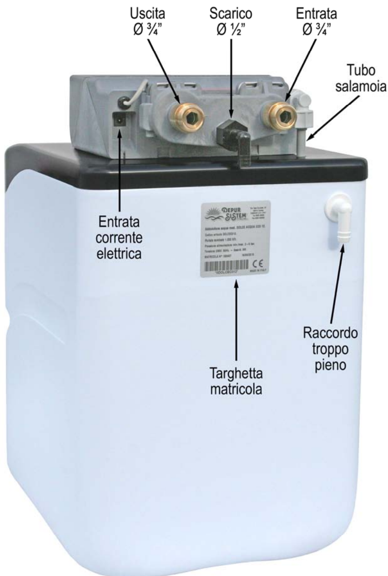
Figura 5: vista posteriore collegamenti addolcitore.
